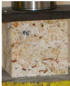
Figure 12. Essais de compression sur éprouvettes cubiques
