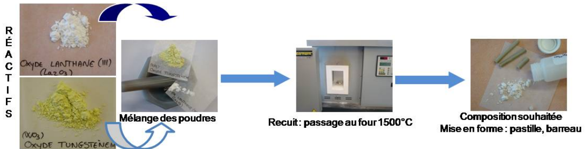
Figure 1 : Étapes de la synthèse par voie solide-solide
