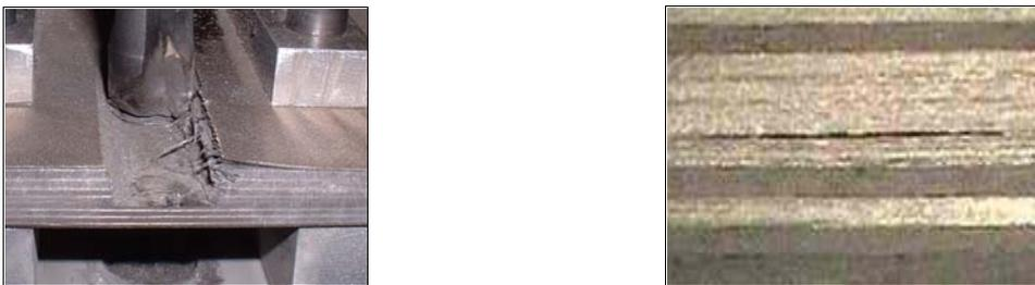
Figure 1. Défauts d'écaillage (à gauche) et de délaminage (à droite).
