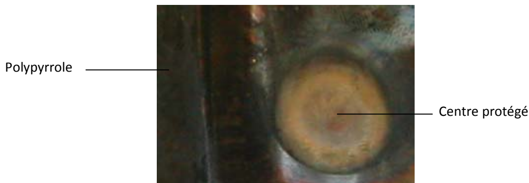
Figure 5. Photographie du substrat obtenu sous les US focalisés
