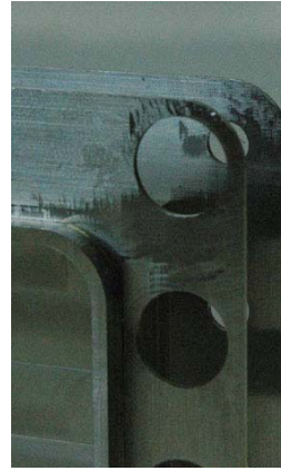
Photo 6. Ailette droite non vibrée
