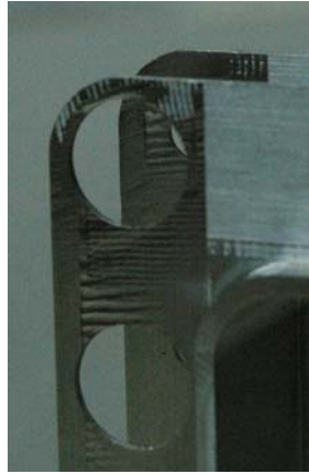
Photo 5. Ailette gauche vibrée
